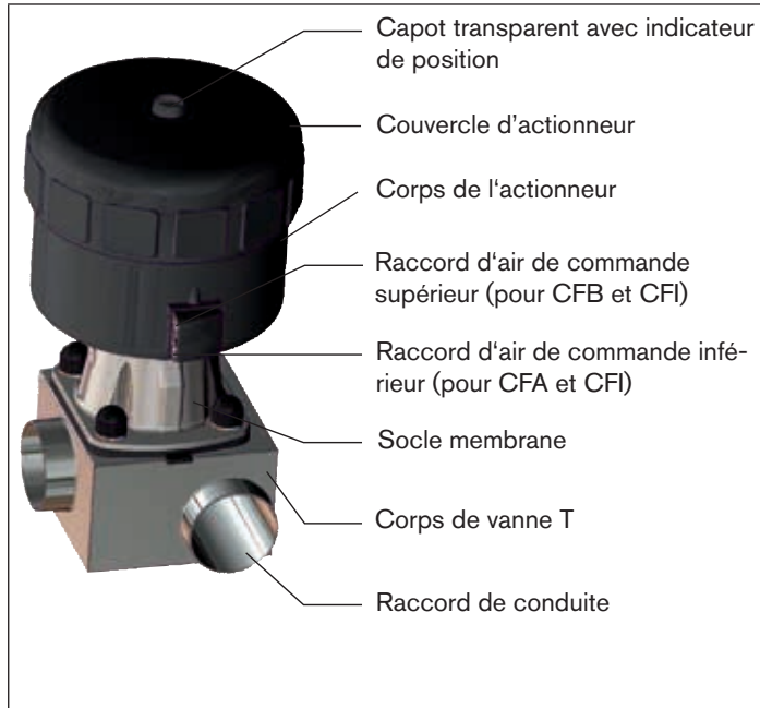
Fig. 9 : Structure et description Type 2032
