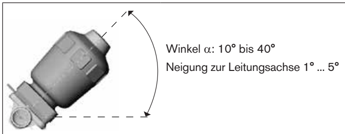
Bild 12: Einbaulage zur Selbstentleerung des Gehäuses
